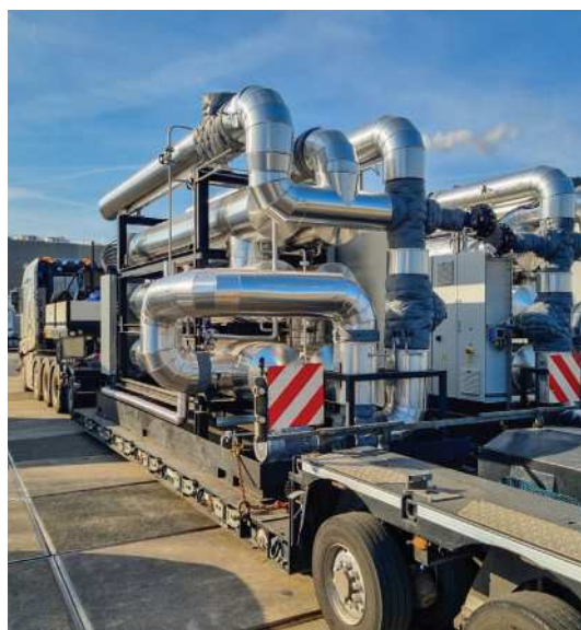
Chaudières à huile thermique électriques
